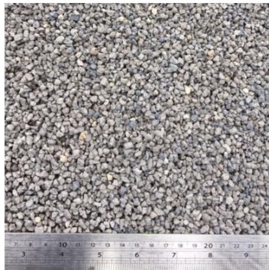
圖 2.3 滾筒轉爐石(細粒料；型號：AC1)外觀圖
